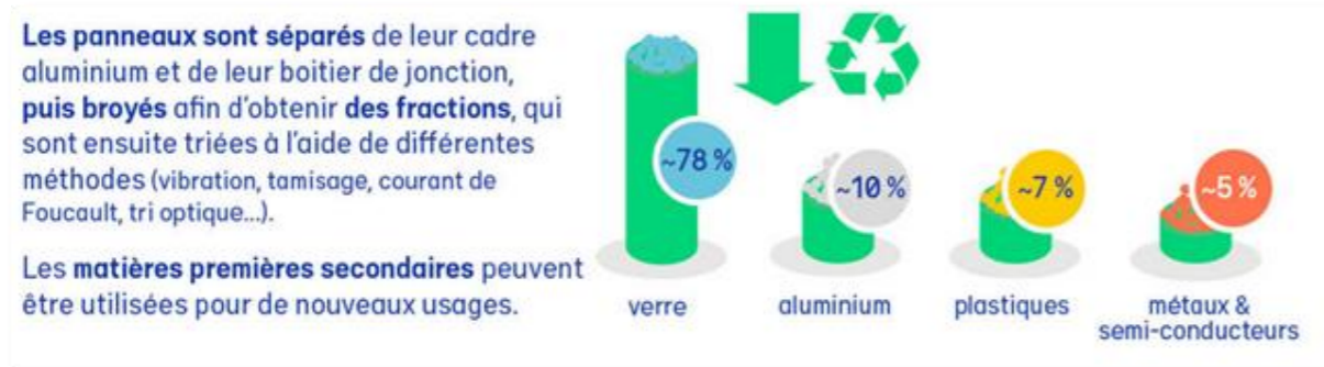
Figure 19 : Procédure de recyclage des panneaux (source : SOREN)
